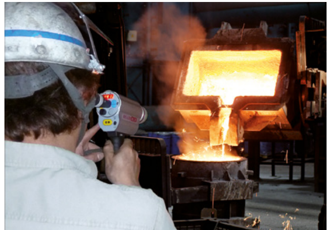
Fig. 7 Un pyromètre portable Panorama utilisé pour la mesure d'une coulée.
