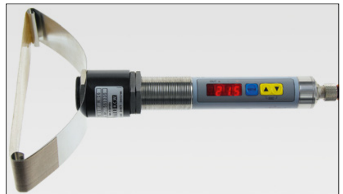
Fig. 6 Arc en téflon pour mesurer une tôle en acier Inox
