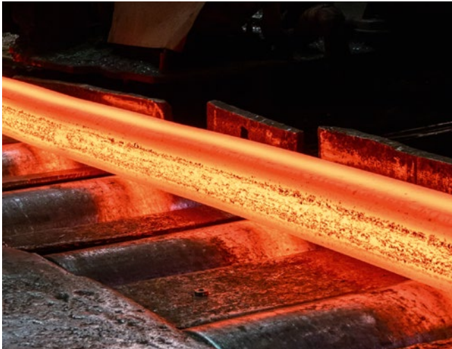
Les oxydes et la calamine changent fortement les propriétés radiatives
