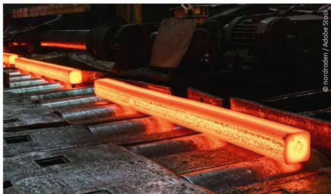
L'écaillage et l'oxyde modifient considérablement les propriétés du rayonnement
