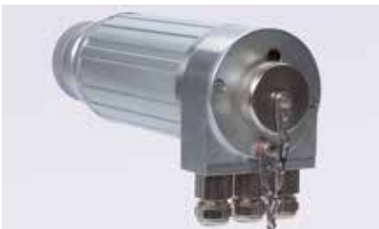
Gamme CellaTemp® PZ Pyromètre fixe avec connexion Profibus, lentille focalisable, visée directe et pointeur laser.
