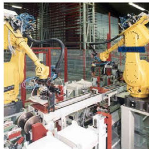
Zwei 6-Achs-Knickarm-Roboter mit Kombigreifer-Saugvorrichtung bilden Päckchen aus Zubehör-Dachziegeln mit einer Zwischenlage aus Papier Kunde: Walther Dachziegel, Langenzenn
