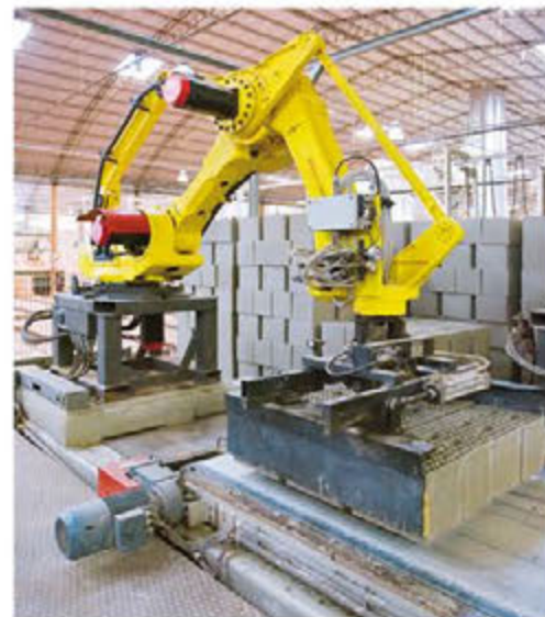
4-Achs-Palettierroboter mit pneumatischem Greifer Kunde: Laterzi Fauci, Werk Sciacca (Italien)
