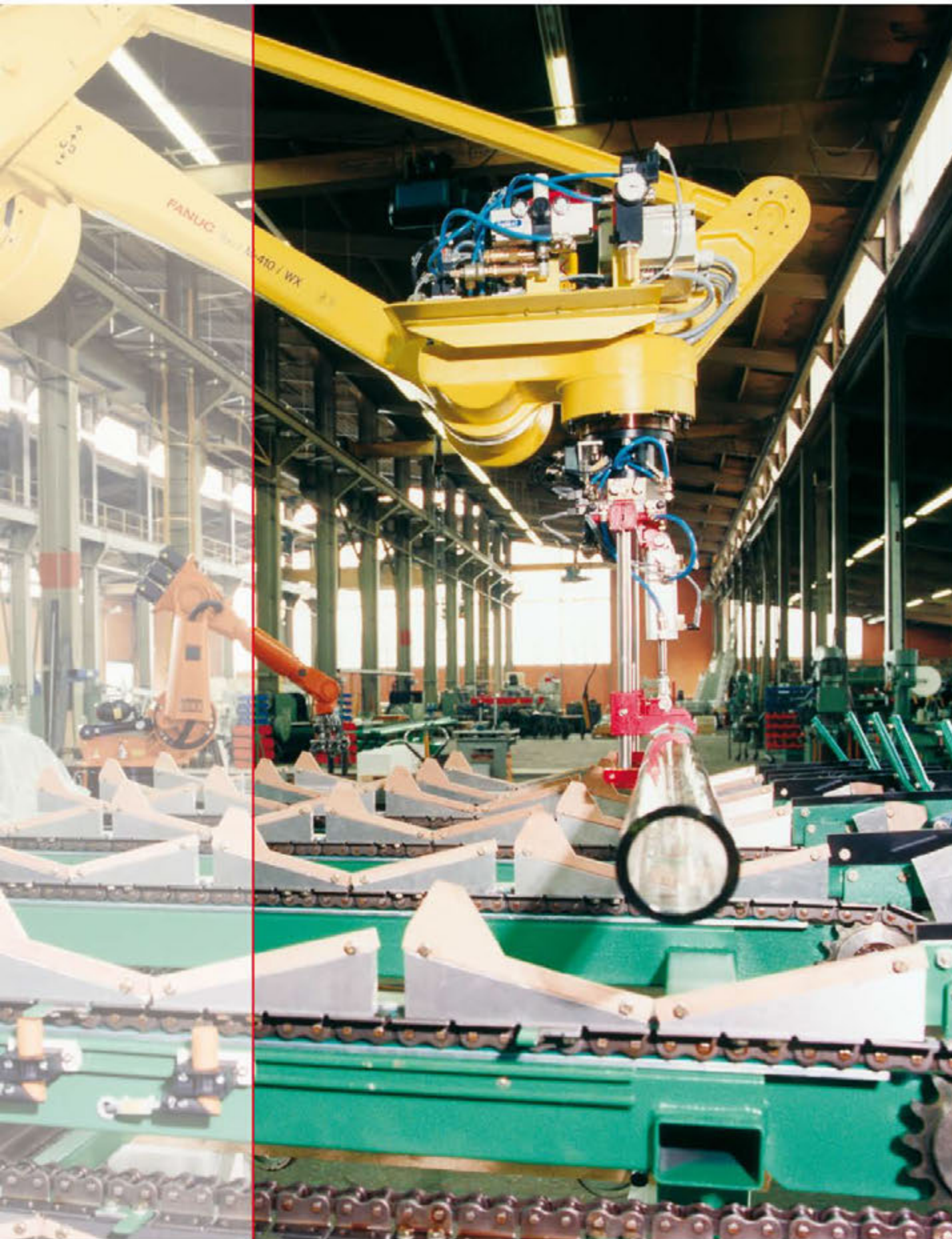
Glasröhrenhandling mit Spezialgreifern im Probelauf bei KELLER in Ibbenbüren-Loggenbeck
