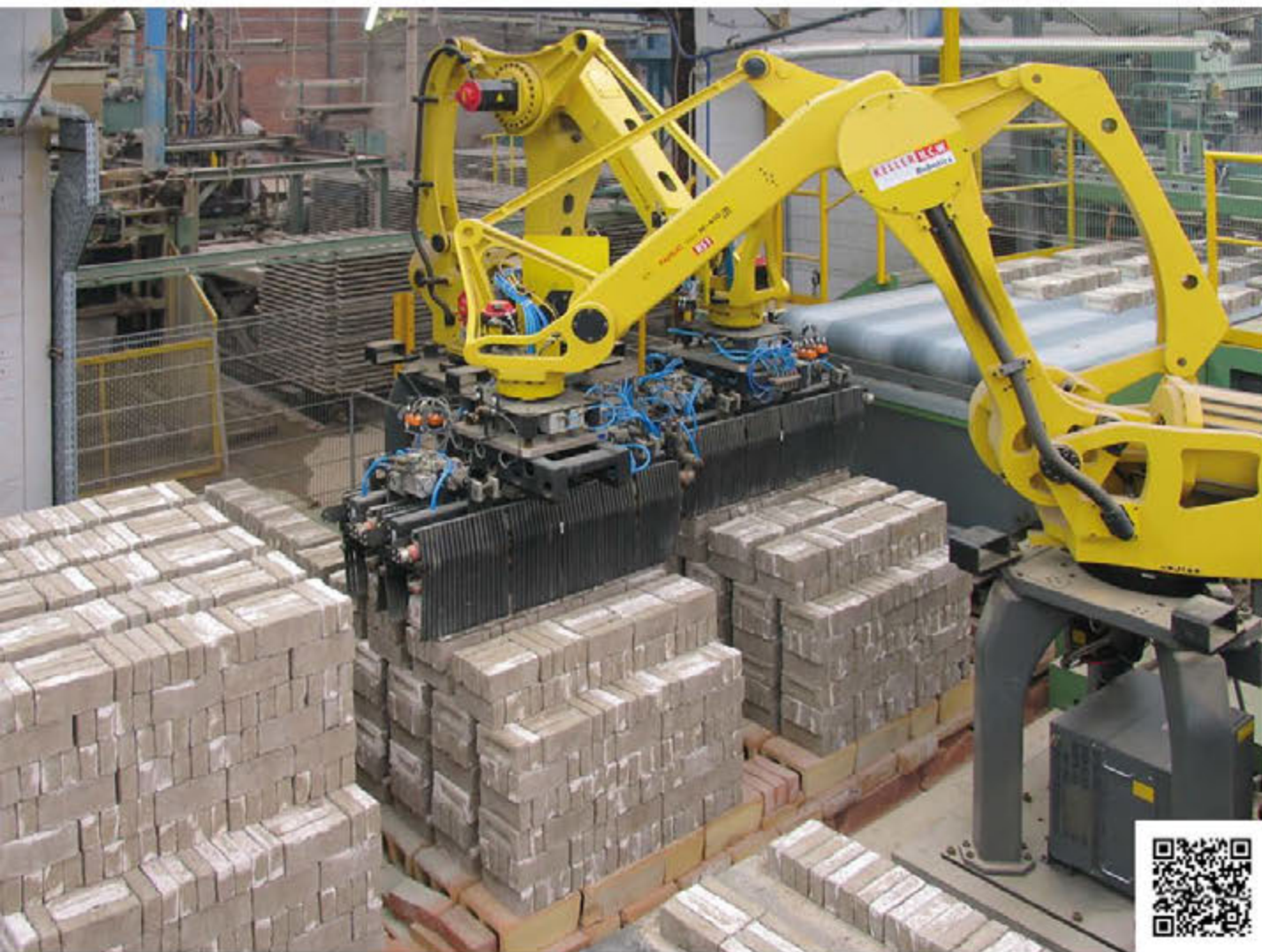
Zwei 4-Achs-Palettierroboter mit pneumatischen Spreizgreifern für den Ofenwagenbesatz von Soft-Mud-Steinen Kunde: SVK, Sint-Niklaas, Belgien
