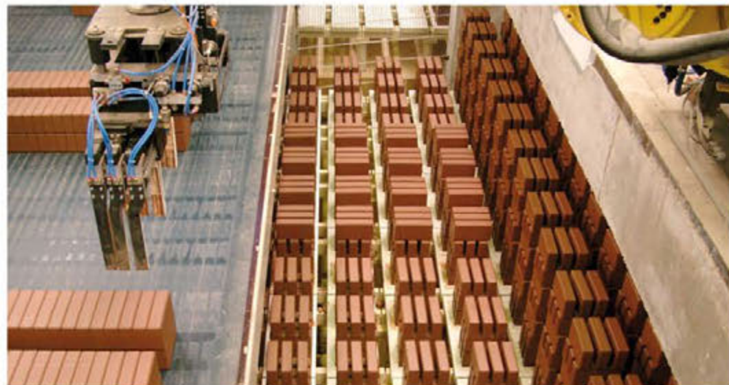
Mit der KELLER-Applikation Kmatic VR generiertes Setschema für Strangziegel Kunde: Malpesa, Werk 4, Bailen (Spanien)
