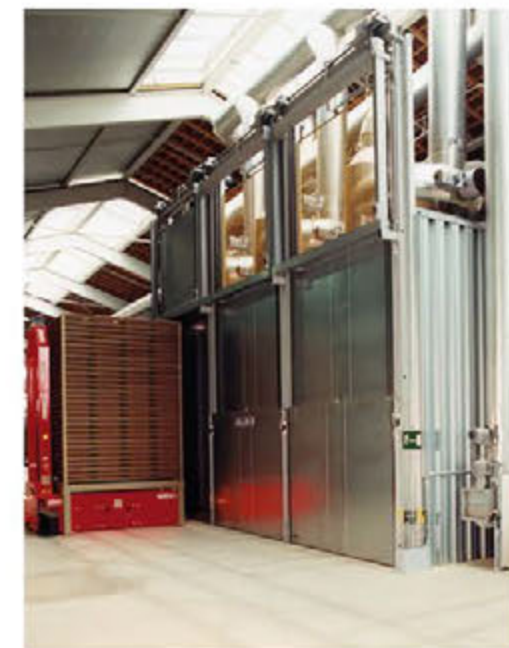
Erstes fahrerloses Transportsystem FTS in einem Ziegelwerk (1999) Kunde: F. v. Müller Dachziegel, Werk Görlitz
