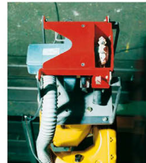
Fräsroboter zum Fräsen von Griffmulden in Porenbetonsteine
