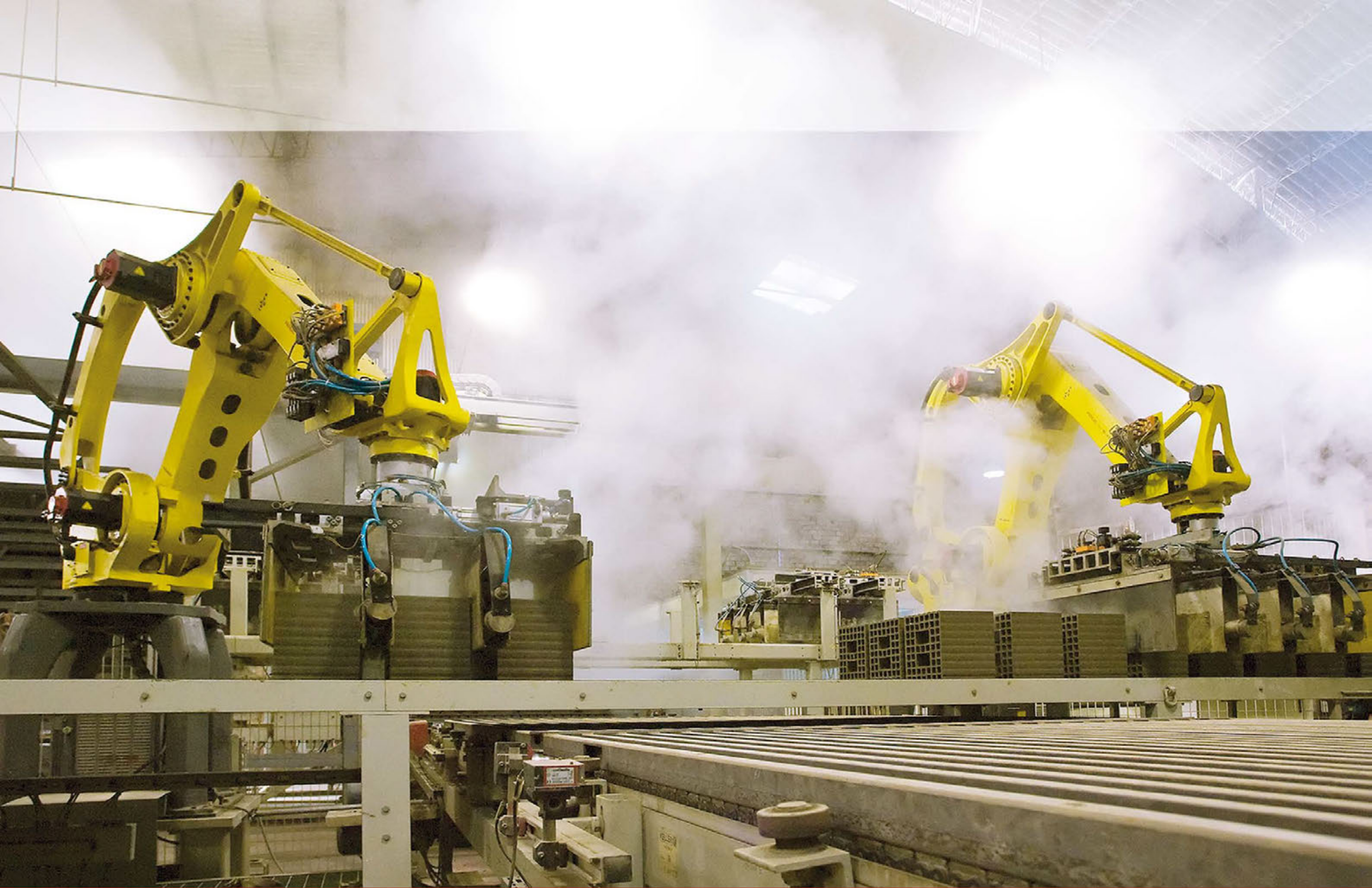
Zwei 4-Achs-Palettierroboter setzen die frisch extrudierten und geschnittenen Ziegel mit pneumatischen Greifern auf große Trocknerpaletten Kunde: Laterzi Facci, Sciocca (Italien)
