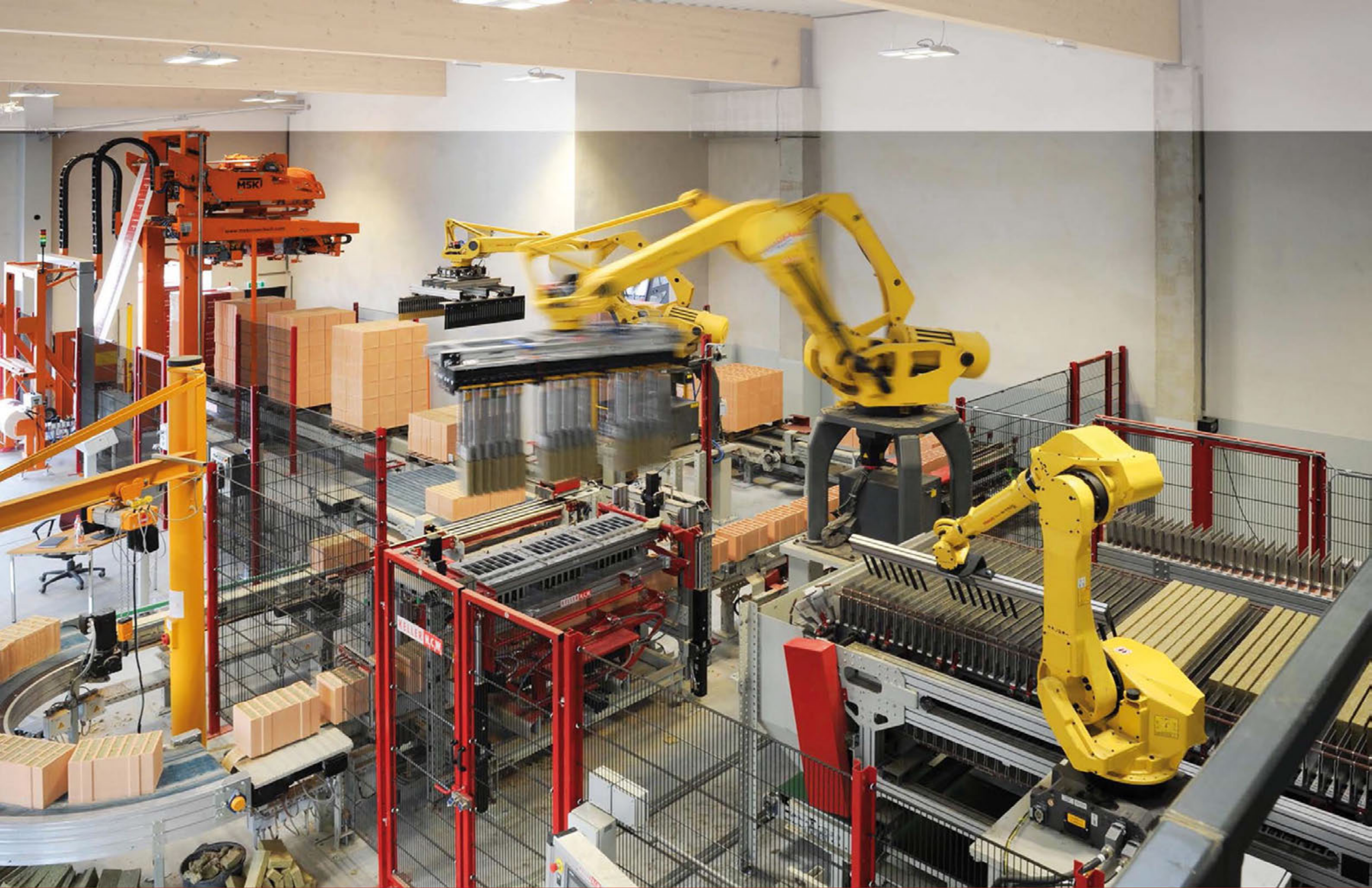
Erste Roboteranlage zum Verfüllen von Hintermauerziegel mit Mineralwolle in Österreich (2013) Kunde: Wienerberger Ziegelindustrie, Werk Haiding (Österreich)
