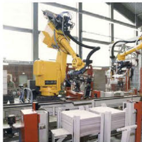
Zwei 6-Achs-Knickarm-Roboter mit Kombigreifer-Saugvorrichtung bilden Päckchen aus Zubehör-Dachziegeln mit einer Zwischenlage aus Papier Kunde: Walther Dachziegel, Langenzenn
