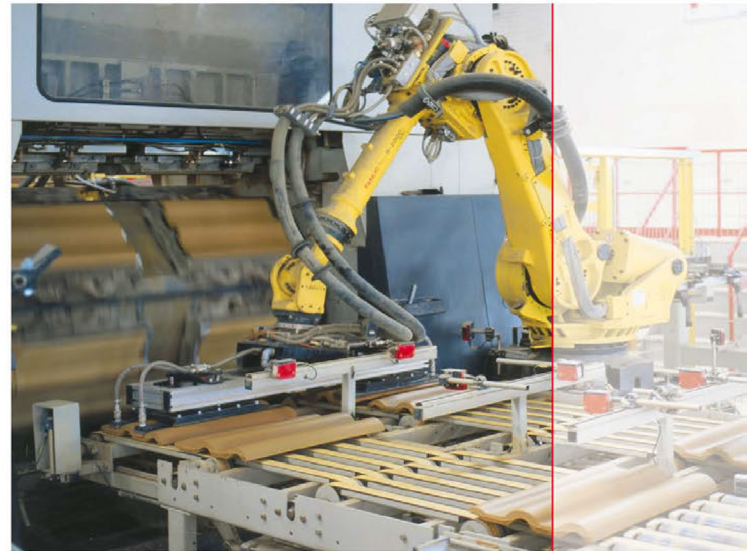
Ein 6-Achs-Knickarmroboter lädt vorgeformte Flächenziegelbatzen in eine Revolver-Dachziegelpresse Kunde: Nibra, Groß-Ammensleben
