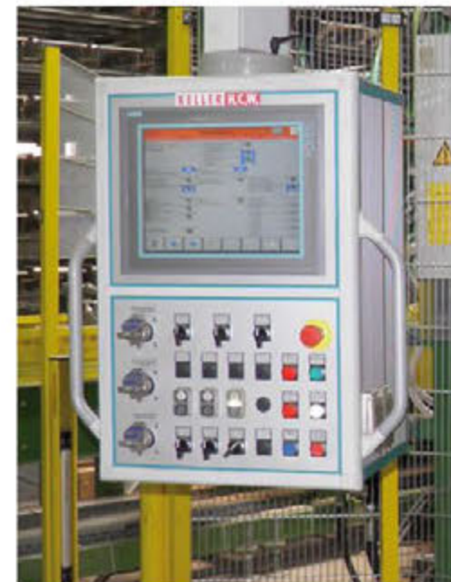
Schwenkbares Bedienfeld mit Touch-Screen Kunde: Röhren Tonbaustoffe, Werk Brüggen
