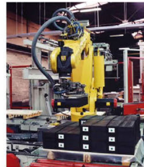
Feuerfestmaterialhandling mit Sauggreifer Kunde: Didier-Werke, Werk Duisburg
