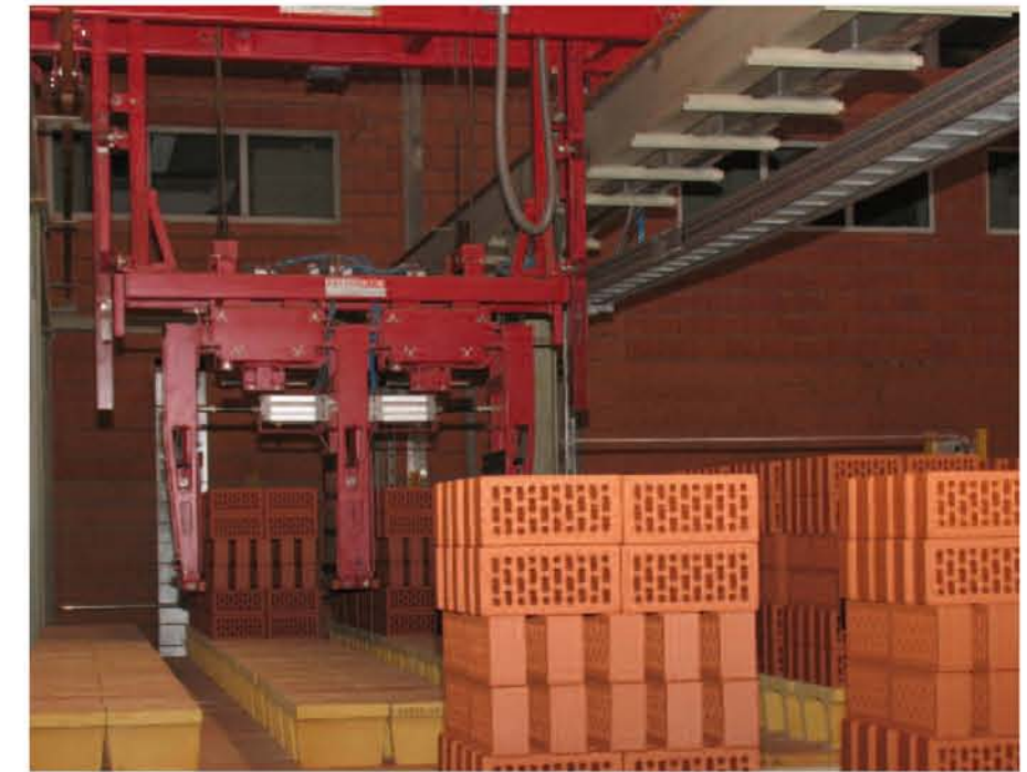
Ofenwagenentladung mit Paketgreifern
