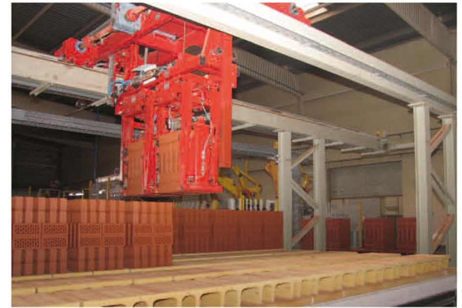
Ofenwagenentladung mit Paketgreifer
