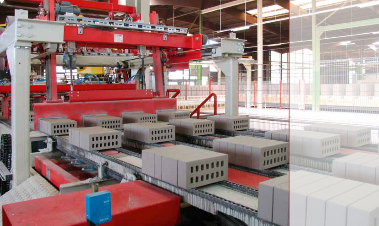
Sortierbahn zum Zufahrtisch – Paketierung
