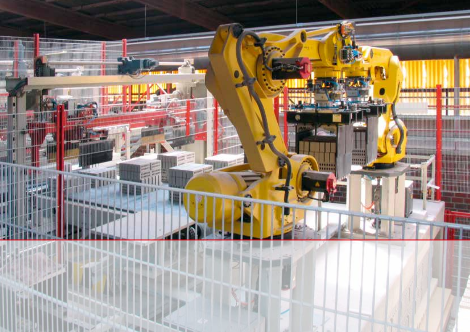
Ofenwagenbeladeposition – 2 Roboter mit Schichtengreifern
