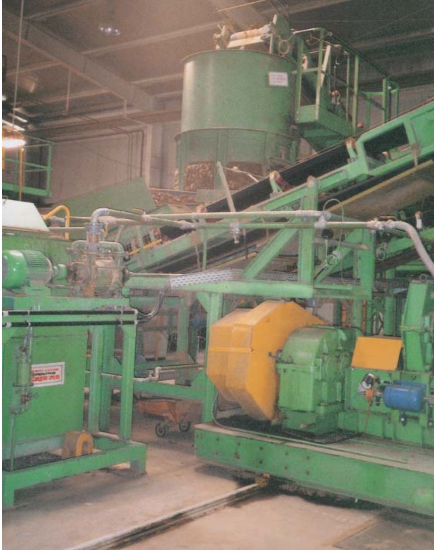
Глиномялка для загрузки различных производственных участков
