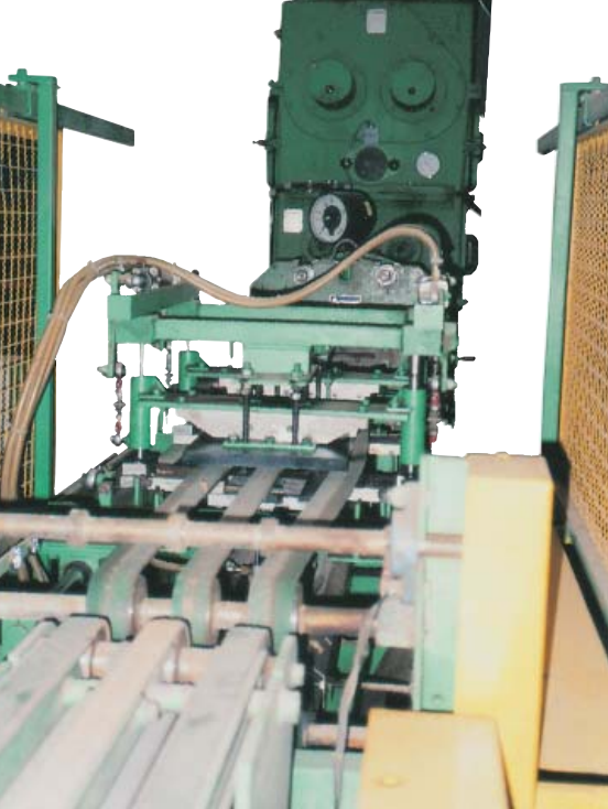
Автомат-штамповщик для раскроя ленточной черепицы
