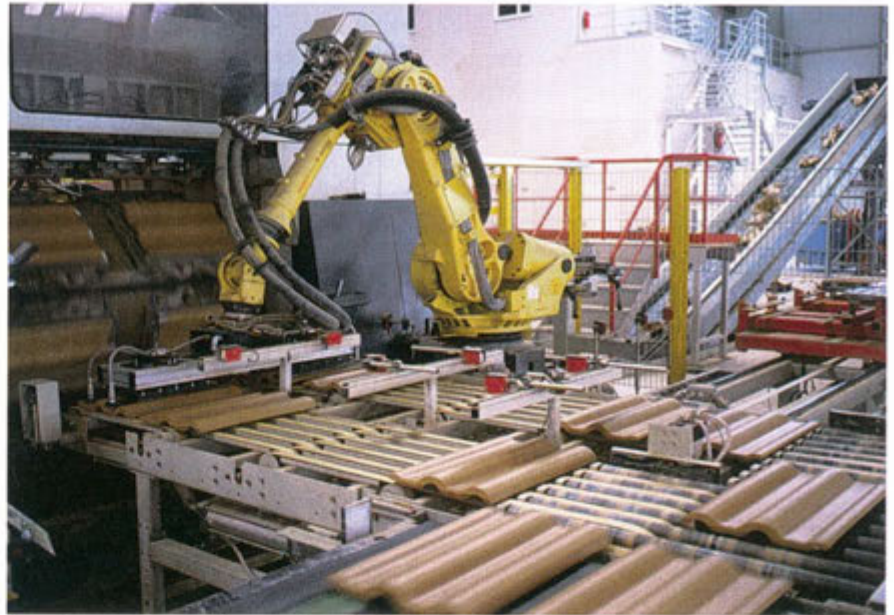
Vorgeformte Batzen gelangen über die Keller-Batzenzuführung und Keller-Roboter auf die Pressentrommel der Händle-Dachziegelpresse Nova II Pre-shaped bats are fed via Keller bat feeding device and Keller robots onto the press drum of the Händle roofing tile press Nova II
