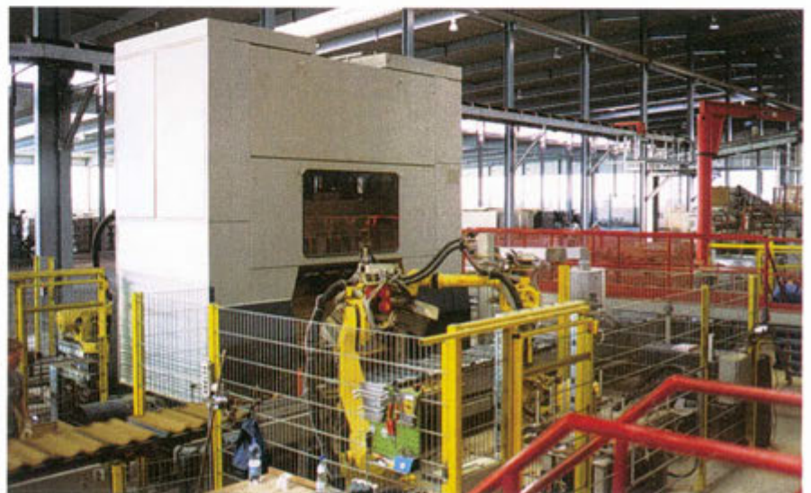
Zwei Keller-Roboter an der Händle-Dachziegelpresse Nova II mit Tema-Messerkästen zum Ausstechen, Absaugen und Übersetzen von gepressten Dachziegeln Two Keller robots at the Händle roofing tile press Nova II with Tema suction heads for cutting out, sucking and transfer of pressed roofing tiles
