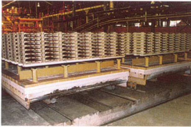
Tunnelofenwagen im Zubehörwerk Tunnel kiln car in the accessories works
