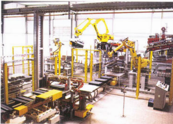
3 Roboter verarbeiten Hand in Hand die zugeführten Produkte zu Versandpaketen 3 robots work hand in hand to form dispatch packs of the products supplied
