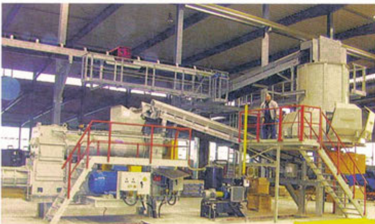
Händle-Doppelwellenextruder Type PZVMGD 45a/35/920e und Siebrundbeschicker Type BRSH 19b Händle double-shaft extruder Type PZVMGD 45a/35/920e and circular screen feeder Type BRSH 19b
