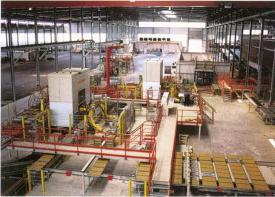
Flächenziegel-Formgebung: Keller-Robotertechnologie zum Be- und Entladen der Dachziegelpressen Shaping of standard roofing tiles: Keller robot technology for loading and unloading the roofing tile presses
