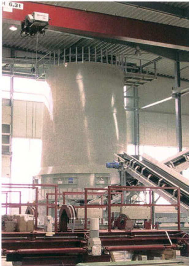
Händle-Tonsilo Type AGR 65c zum Speichern von Betriebsmasse zwischen Quersumpf und Flächenziegelproduktion Händle clay silo Type AGR 65c for storing mass between cross-dredging sump house and standard roofing tile production plant
