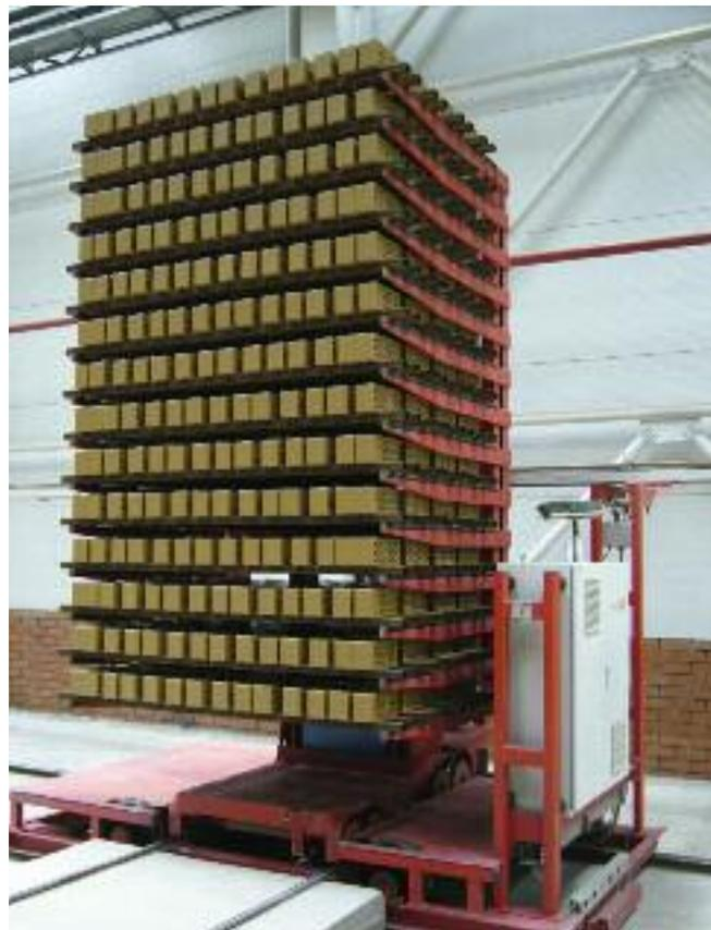
Schienegebundener Absetzwagen zum Transport der beladenen Formlingsträger in die Trockenkammern
