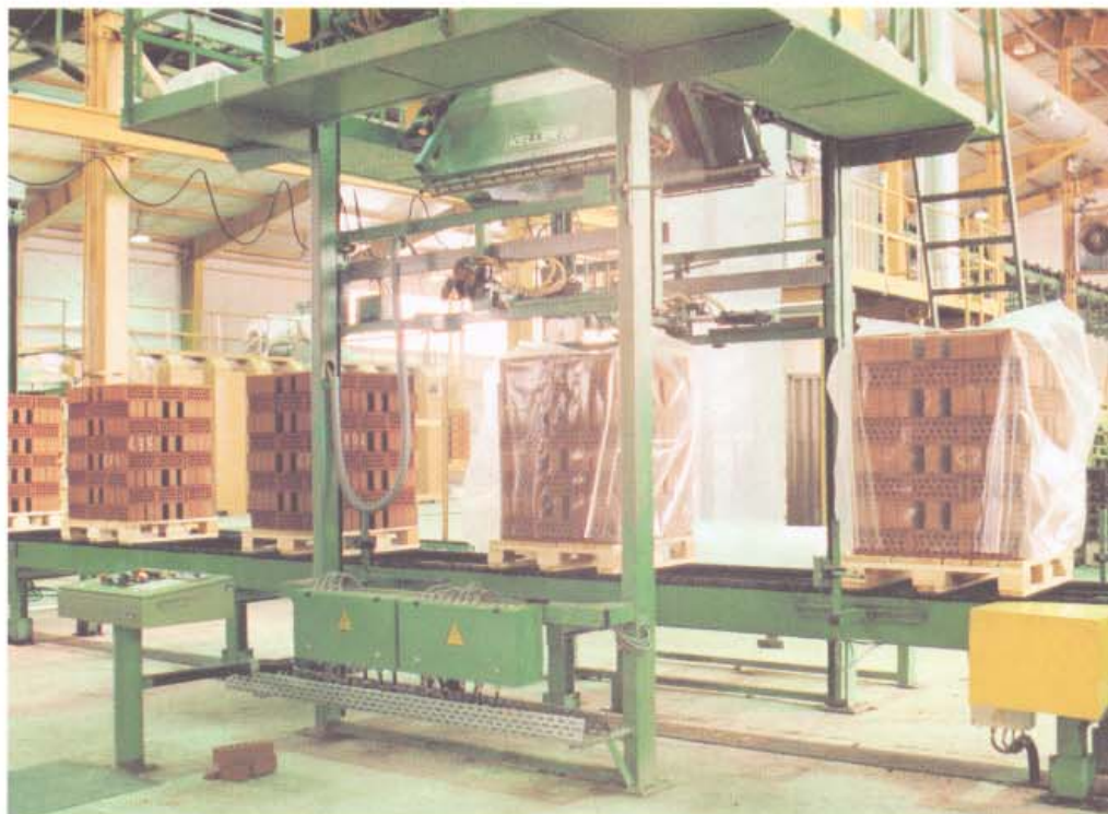
Folienhaubenautomat zur Bildung von Folienhauben und Überziehen derselben über die Versandpakete.
