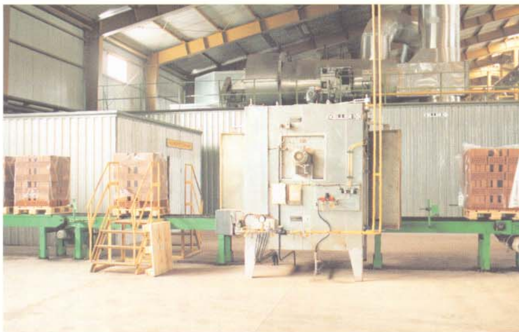
Gasbefuerter Ofen zum Einschrumpfen der Versandpakete.
