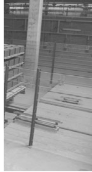
Trocknerwagen mit nassen Formlingen vor dem Nassspeicher
