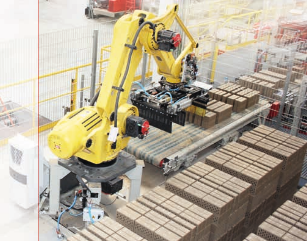
Roboter-Setzanlage Участок садки с роботом
