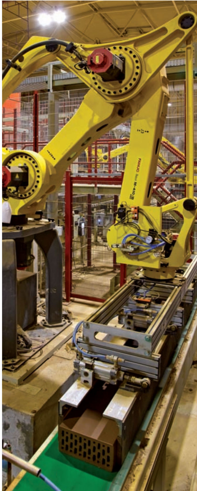
Übersetzroboter mit Batzengreifer
