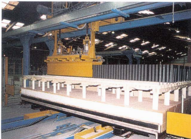
Der Setzgreifer setzt eine Formlingsreihe auf dem Ofenwagen ab The setting gripper places a row of products onto the kiln car
