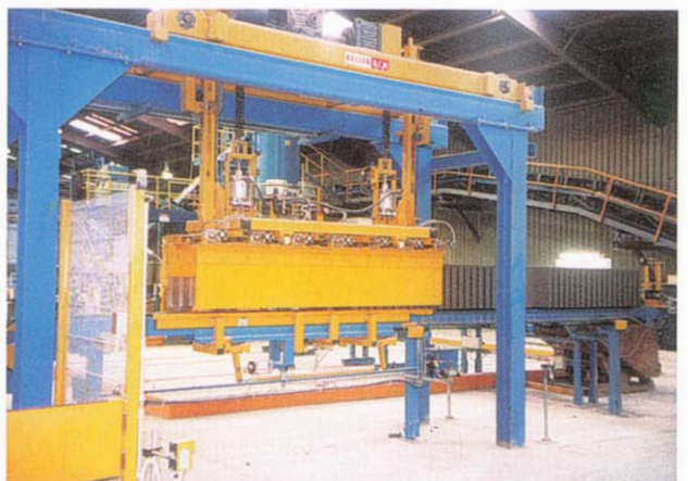
Der Spaltplatten-Setzgreifer ist zum Aufnehmen einer Formlingsreihe bereit The split tile setting gripper is ready to pick up a row of shaped products
