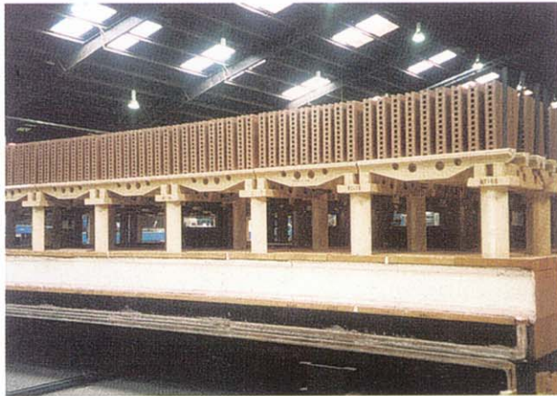
Ofenwagen mit Cordierit-Fischbauch-Balkenaufbau Kiln car with cordierite fish-bellied beam superstructure
