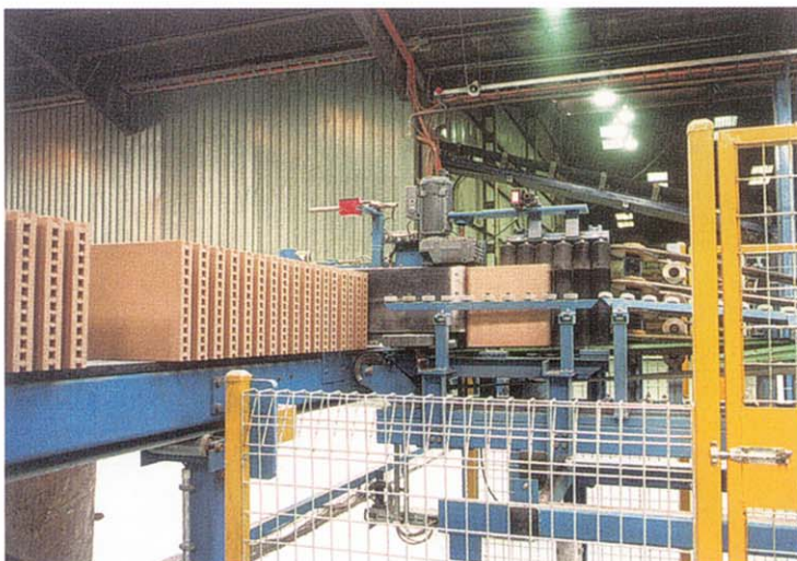
Abschubeinrichtung mit Flachlegeeinheit Push-off device with lay-flat unit
