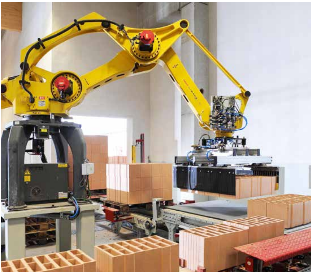
Palettieren von Verfüllziegeln mit Roboter Palletizing of filling bricks with robot
