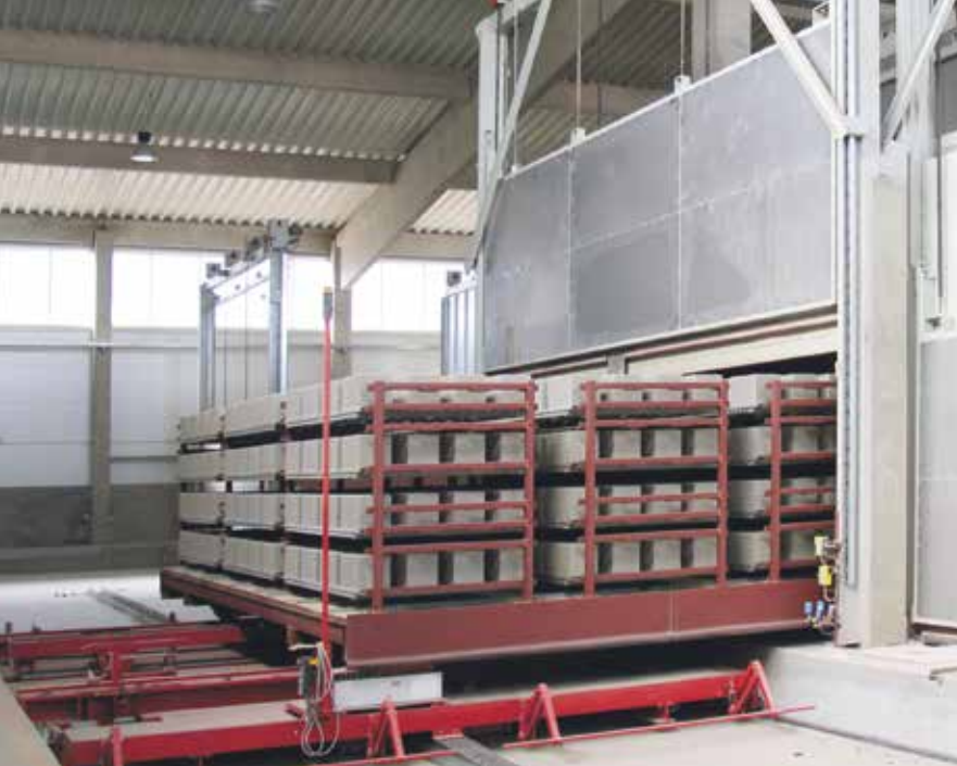
Trocknerausfahrtschleuse Dryer exit sluice
