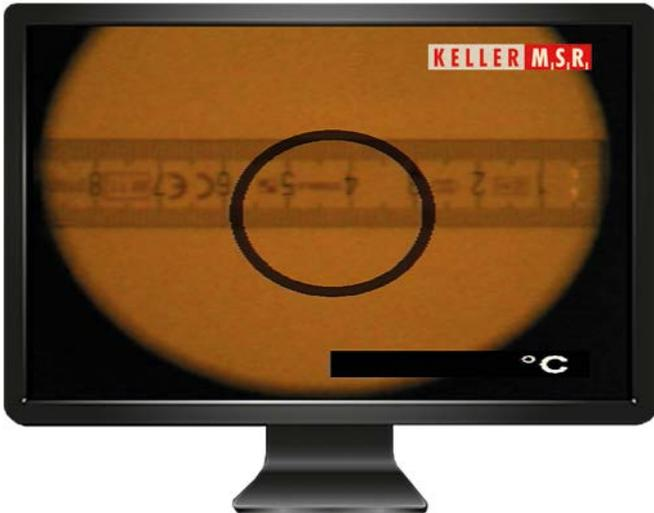
Videobild des Pyrometers CellaTemp PA mit Blick durch ein Rohr in einen dunklen Ofen.
