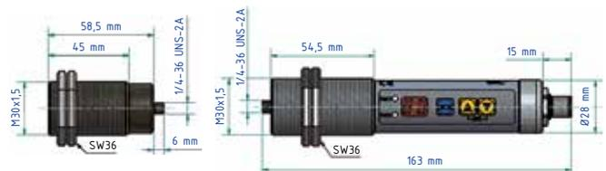
Beim CellaSwitch PKS 21 ist die Elektronik getrennt vom optischen Messkopf. Über einen Lichtleiter wird die Infrarot-Strahlung zur Elektronik übertragen und in ein elektrisches Signal umgewandelt. Der Messkopf ist bei beengten Montagebedingungen, bei hohen elektromagnetischen Feldern und in Umgebungstemperaturen bis 250 °C problemlos einsetzbar.
