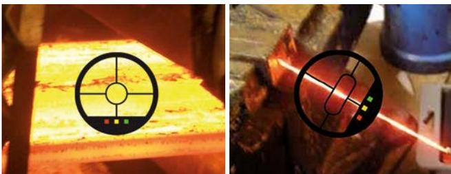
Für eine korrekte Messung muss bei einem Spektralpyrometer das Messfeld vom Objekt voll ausgeleuchtet sein. Zur Kennzeichnung der exakten Größe und Position wird im Durchblick-Visier eine Messfeldmarkierung eingespiegelt. Bei Geräten mit rechteckigem Messfeld ist eine rechteckförmige Markierung eingebaut. Bei einem Quotienten-Pyrometer darf das Messfeld kleiner als das Objekt sein. Dadurch wird die Messung von dünnen Drähten möglich.
