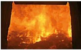
Das CellaPort PT 113 ist speziell zur Temperaturmessung in flammenbeheizten Öfen entwickelt worden. Aufgrund des selektiven Spektralbereiches von 3,9  $\mu\text{m}$  haben Wasserdampf und CO<sub>2</sub> im Sichtfeld des Pyrometers selbst bei großen Messab-
