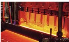
Glas ist im sichtbaren Spektralbereich und im nahen Infrarotbereich transparent. Dabei ist die Emissivität abhängig von der Temperatur, der Wellenlänge, der Glasart und der Dicke des Glases. Im Bereich zwischen 4,6 - 4,9  $\mu\text{m}$  besitzt Glas eine Emissivität von nahezu 100 %.
