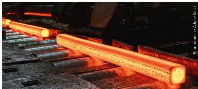
Le scorie e l'ossido modificano in modo significativo le proprietà della radiazione
