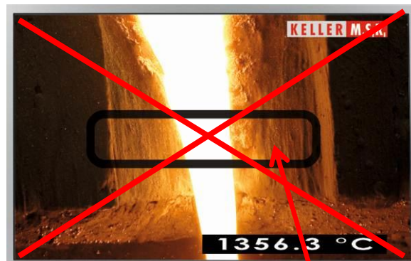
Неправильная наводка поля измерения на желоб (горячий фон)
