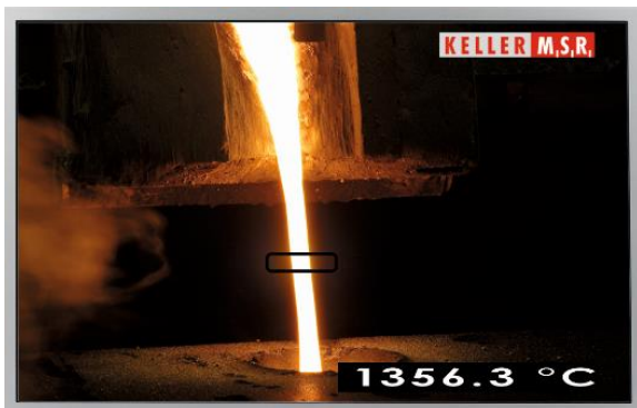
Правильная наводка поля измерения на падающую струю жидкого металла
