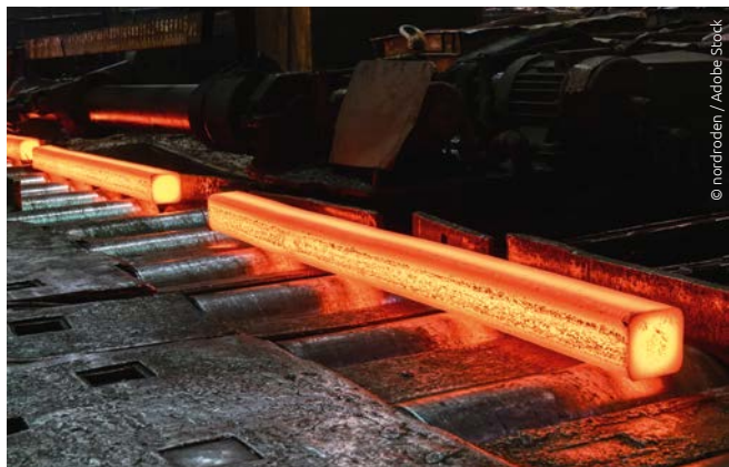
Las incrustaciones y los óxidos modifican significativamente las propiedades de la radiación de los metales.
