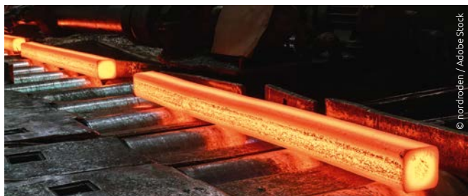
Las incrustaciones y los óxidos modifican significativamente las propiedades de la radiación de los metales.
