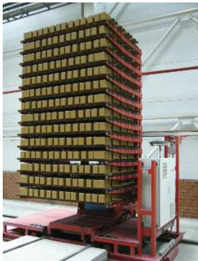
Schiengebundener Absetzwagen zum Transport der beladenen Formlingsträger in die Trockenkammern Тележка на рельсовом ходу для подачи загруженных несущих элементов в сушильные камеры
