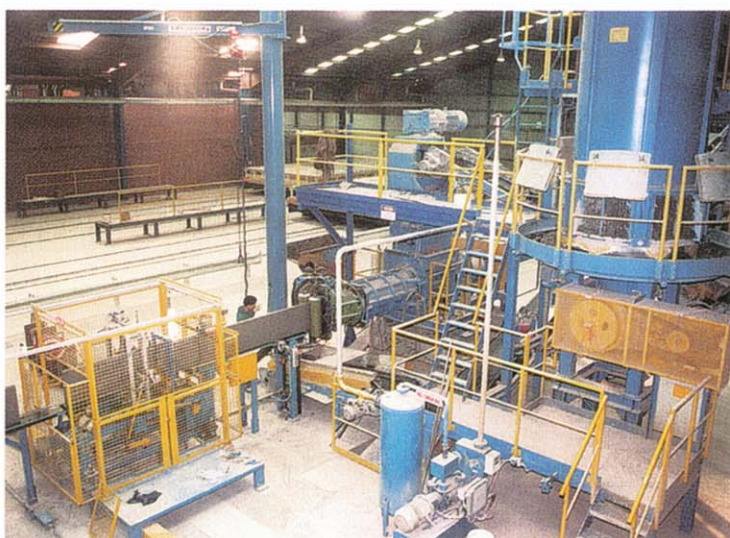
Formgebungsanlage mit Keller-HCW-Spaltplatten-Abschneider Shaping plant with Keller HCW split tile cutter
