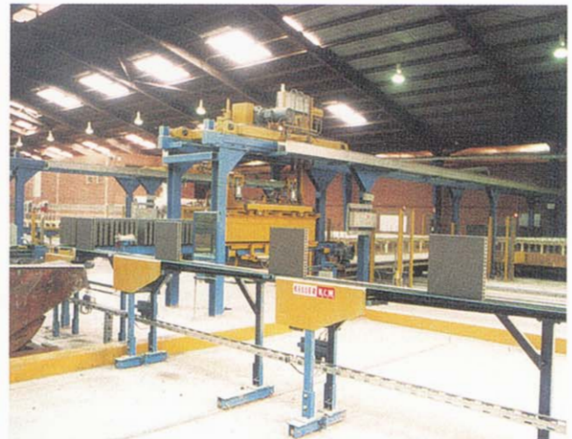
Nasse Spaltplattenformlinge auf dem Weg zur Gruppierung Wet split tiles on their way to the grouping station
