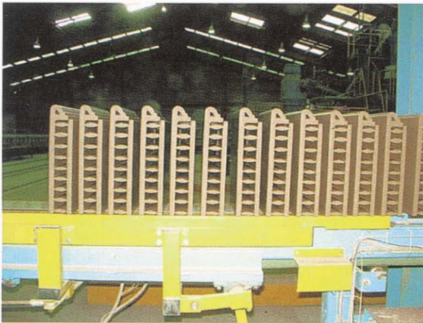
Gruppierte Spaltplatten-Treppenstufen im Bereich der Hub-/Schränkleisten Grouped split tile stair treads at the lift-pull bars
