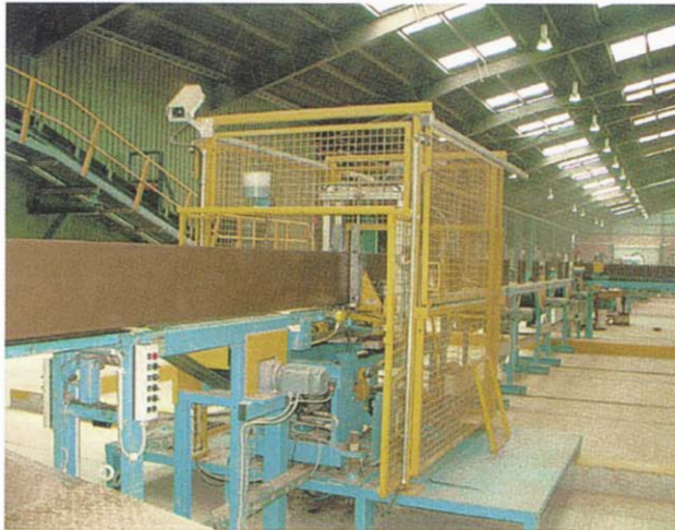
Keller-HCW-Spaltplatten-Abschneider vom Extruder aus gesehen Keller HCW split tile cutter viewed from the extruder
