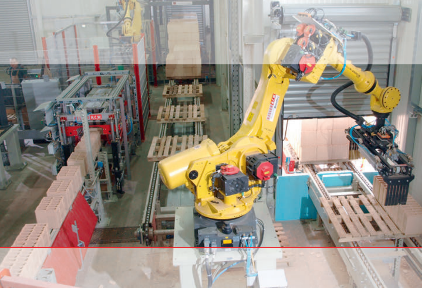
Un robot industrial de alto rendimiento desagrupa, separa y alinea los bloques Um robô industrial de alto rendimento desempilha, separa e agrupa os blocos
