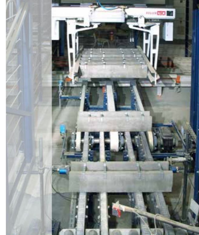
Übersetzer und Rinnenvereinzelung Transfer device and channel separation device
