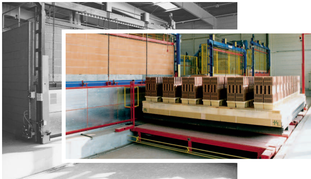
Forno de túnel
