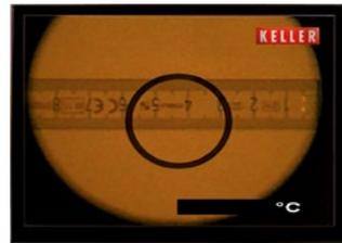
Cuando se utiliza un pirómetro con cámara de vídeo, se puede controlar fácilmente el punto de medición en un monitor de la estación de control en cualquier momento.
