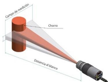
El pirómetro de panorama® de la serie CellaTemp® PA 43 tiene un campo de medición rectangular, logrado de manera óptica, sin necesidad de partes móviles y el blanco se puede mover libremente dentro del campo de medición. Esto ofrece la posibilidad de detectar la
