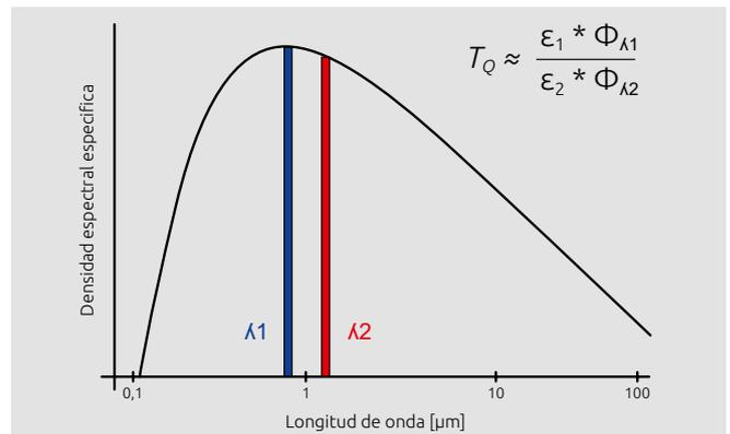
tes, no se ve afectada la lectura de temperatura, cuando los cambios tienen lugar simultáneamente en ambas longitudes de onda.
