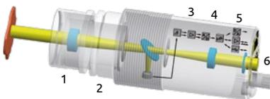
La serie CellaTemp® PA se basa en un concepto modular que consta de los siguientes componentes: sistema óptico, captura y procesamiento
