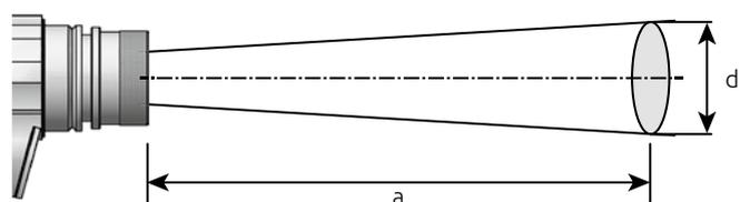
Para los modelos con campo de visión rectangular, se indica la relación óptica de  $D_H$  horizontal y  $D_V$  vertical.
