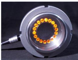
En hornos oscuros a menudo es imposible ver el blanco. Instalando una fuente de luz auxiliar en un segundo taladro puede ser difícil y costoso. Así, en la práctica real, los pirómetros solo se enfocan en el momento de la instalación. La verificación del correcto enfoque durante el posterior funcionamiento, no será posible.
