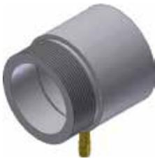
La purga de aire PZ 20/A crea una corriente de aire para evitar que se deposite suciedad en la lente. Si se emplea junto al tubo intermedio PZ 20/C y el anti-polvo PZ 20/T, el sistema proporciona máxima eficiencia y mínimo consumo de aire.
