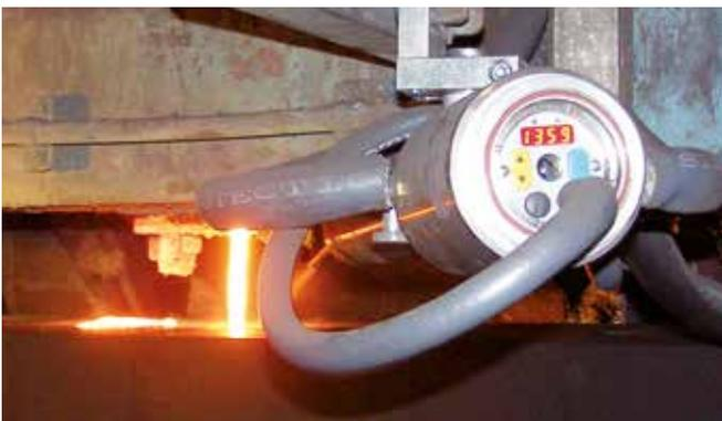
El problema de la medición de la temperatura sin contacto es la creación de óxidos o escorias en la superficie del metal o metaloide fundido. Los cambios en el estado superficial de éste modificarán el factor de emisividad introduciendo errores en la medición.
