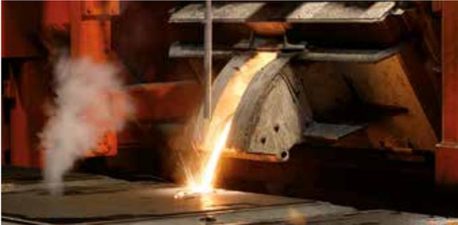
Sólo un pirómetro de radiación es capaz de medir la temperatura en ese momento crucial del proceso: justo el metal o metaloide en estado de fusión se vierte en el molde.
