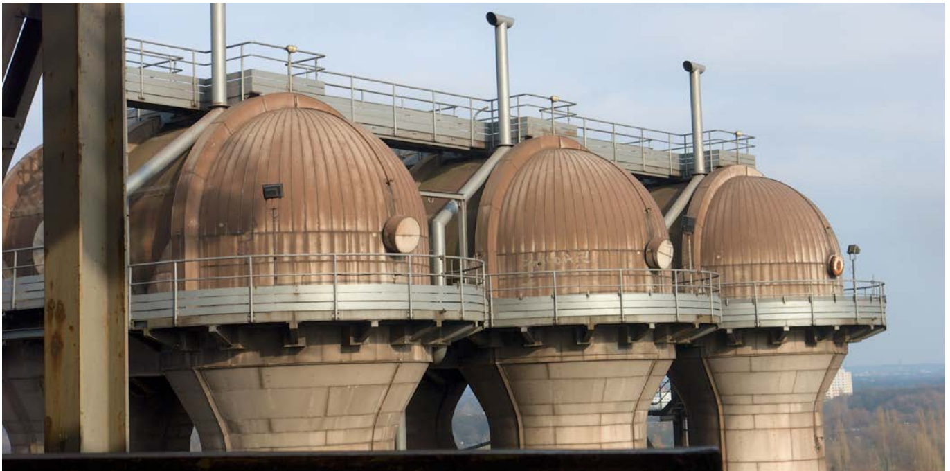
Bild 1 Pyrometer messen von der Kuppel aus die Temperatur der Gittersteine im Winderhitzer.
