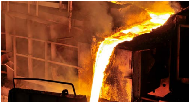
Bild 3 Messstelle Gießrinne mit Schlacke und Oxide auf der fließenden Schmelze.
