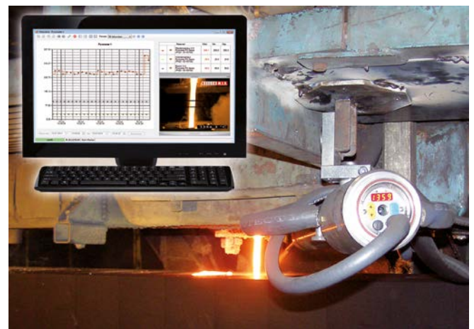
Bild 4 Messstelle am Gießautomat und Monitor zur Anzeige der Gießtemperatur und des Videobildes.
