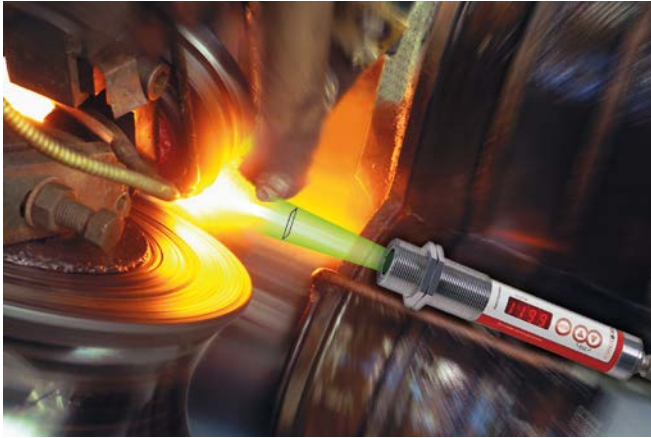
Bild 1 Ein Quotienten-Pyrometer mit rechteckigem Messfeld erfasst selbst bei einem schwingenden Draht präzise die Temperatur.
