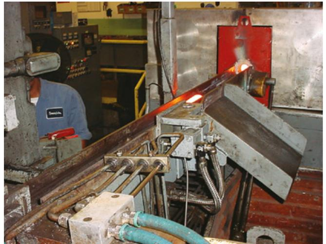
**Bild 9** Schleuse zum Aussortieren der Bolzen mit zu niedriger oder zu hoher Temperatur.
