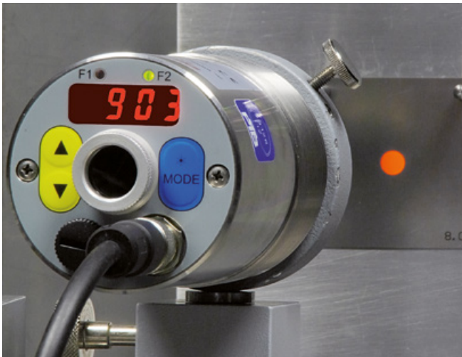
Bild 4 Ermittlung der optischen Eigenschaften eines Strahlungsthermometers
