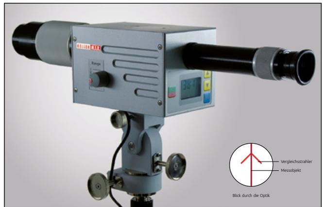
**Bild 3** Intensitätsvergleichspyrometer PV 11 zur genauen optischen Temperaturmessung.
