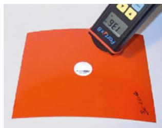
**Bild 2** Ermittlung des Emissionsgrades durch eine Vergleichsmessung auf einem Epsidot.
