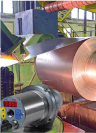
Bild 8 Mit modernen Gleichlicht-Pyrometern lassen sich Temperaturmessungen von blanken Metallbändern in einer Beschichtungsanlage ab 75 °C messen.
