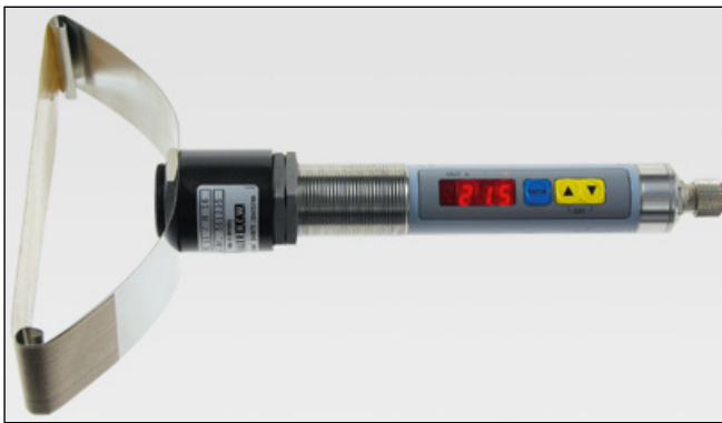
Bild 6 Bügel mit einem Teflonband zur Messung an blanken Walzen.
