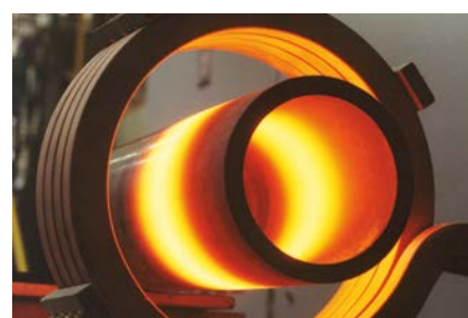
Riscaldamento a induzione
