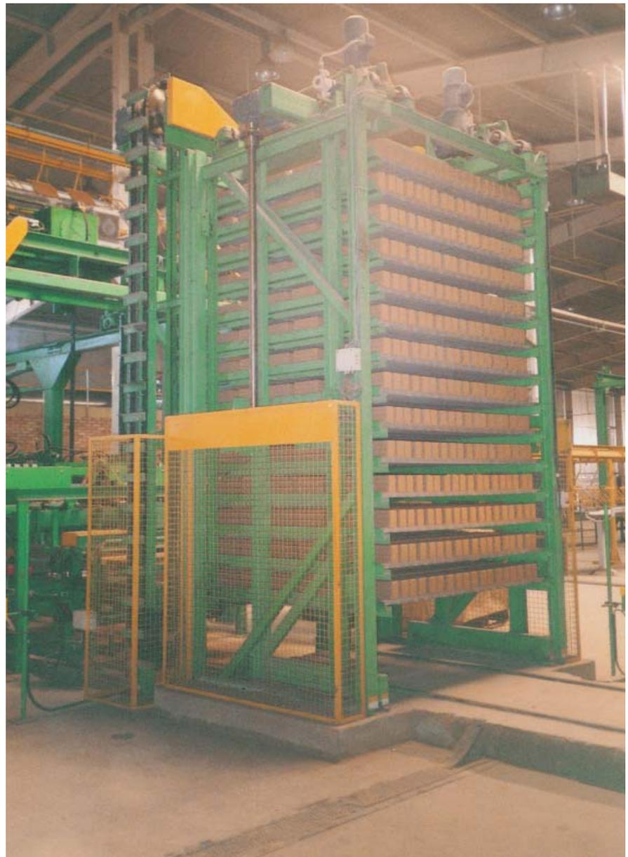
Nach dem Trocknen werden die Formlinge analog zur Naßseite mit dem Absetzwagen aus der Trocknerkammer entnommen und der Trockenseite zugeführt.
