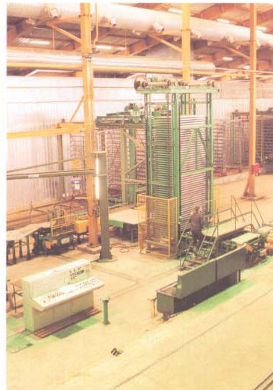
Die Naßseite mit KELLER Universal-Abschneider, Lattenspeicher und Tunneltrocknerwagenbeladung.
