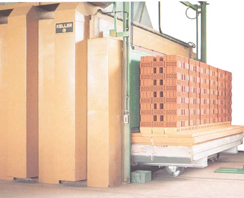
Tunnelofenausfahrt mit einem Tunnelofenwagen mit gebrannten Steinen. Kонец печи: одна из вагонеток, загруженная обожжёнными кирпичами.
