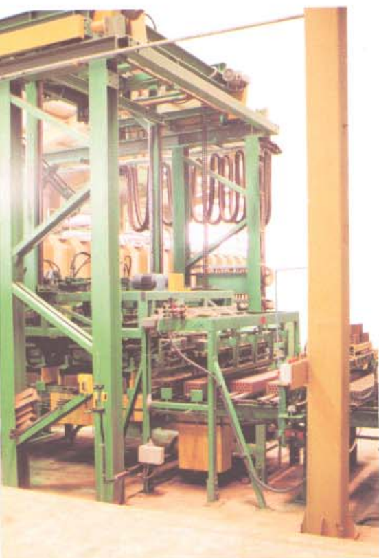
Gruppierereinrichtung zum Gruppieren der getrockneten Formlinge im Bereich der Setzmaschine.
