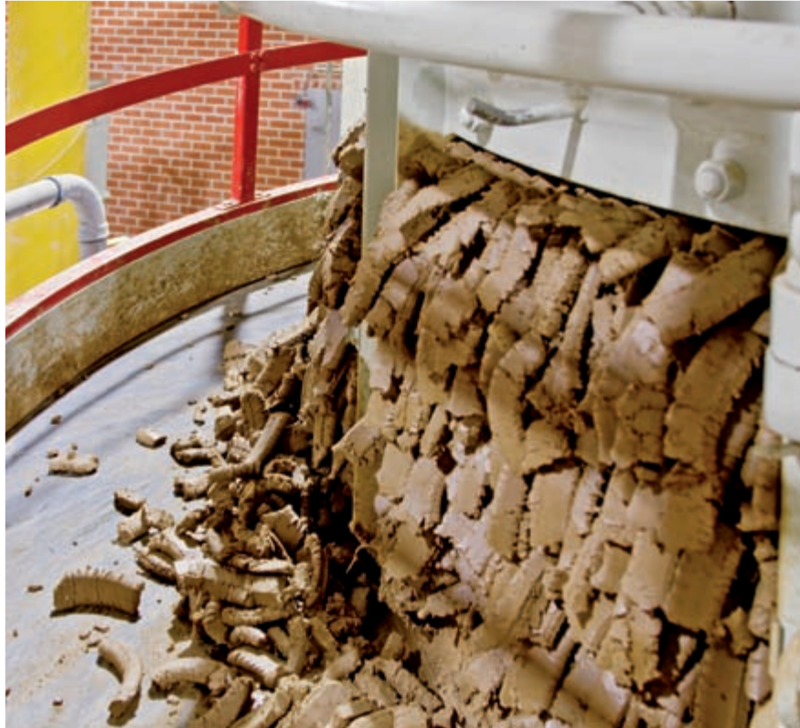
Materialaustritt auf den Sammelteiler des Siebrundbeschicker
