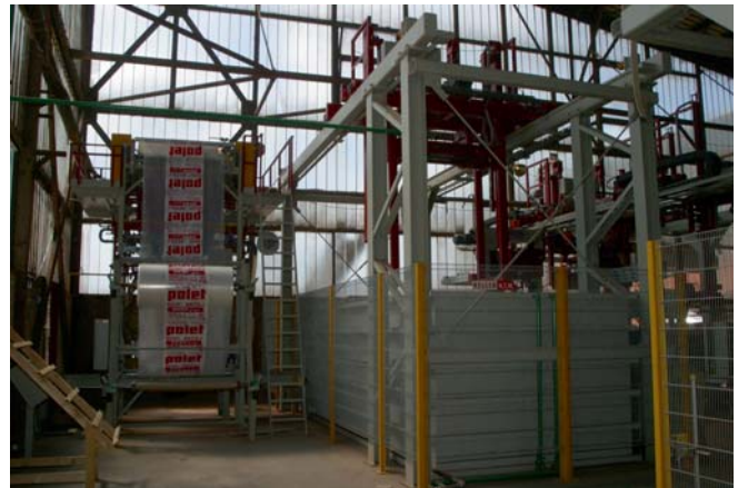
Tauchanlage für Versandpakete und Folienhaubenautomaten Dipping plant for dispatch packs and film hood machine
