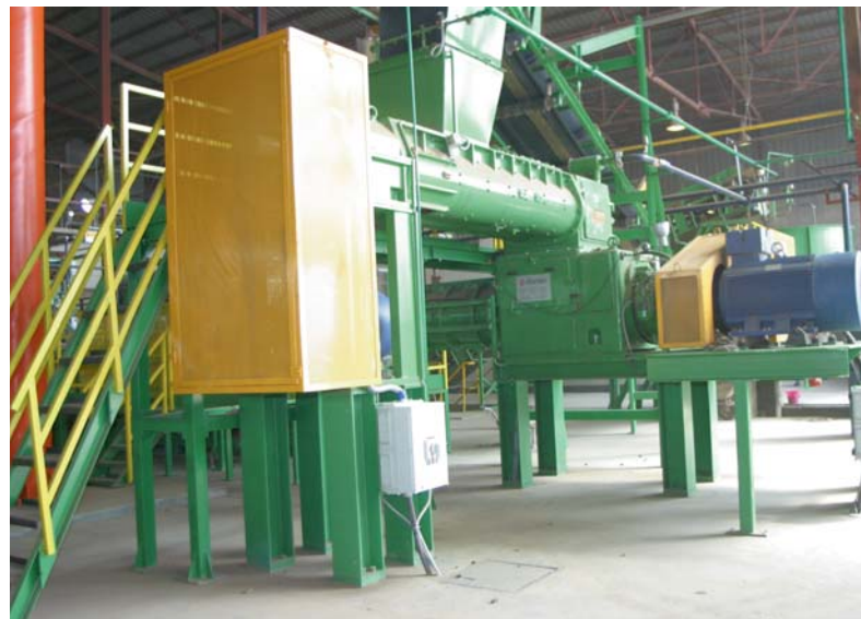
Neuer Extruder für die Batzenherstellung New extruder for the slug production
