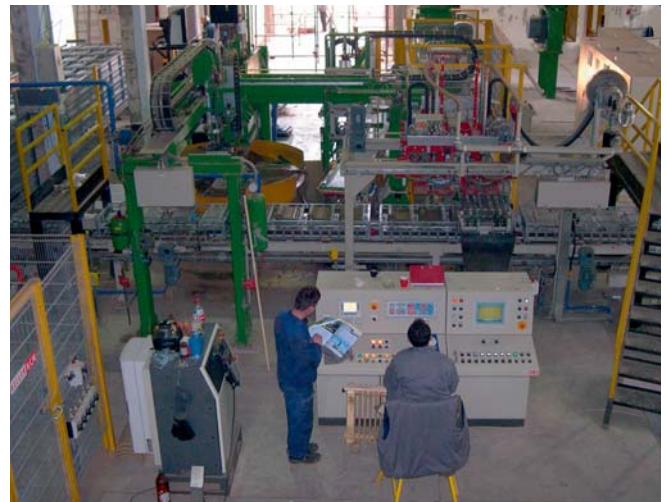
Gepresste Formziegel (Drehtischpresse) oder extrudierte Dachziegel (KELLER-Dachziegelstanzer) werden auf stapelbare Wenderahmen abgelegt Pressed shaped tiles (turntable press) or extruded roof tiles (KELLER HCW roof tile puncher) are set down on stackable turn-over frames.
