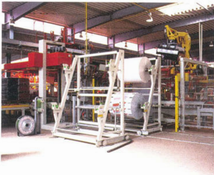
Verfügbarkeit: Zum Wechseln von Folienrollen steht ein Folienständer bereit Availability: A film rack is available for changing film rolls
