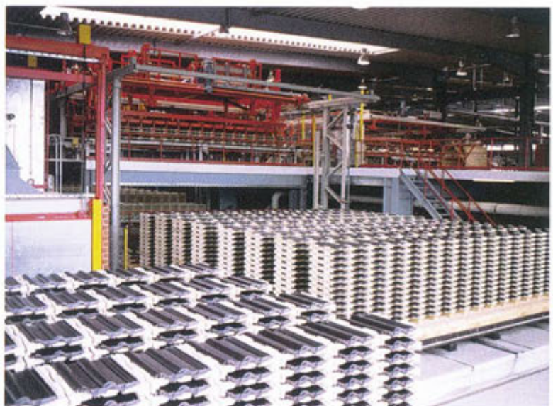
Qualität: Nach 10,4 Stunden verlassen die Ofenwagen den Tunnelofen und werden der Entladung zugeführt Quality: The kiln cars leave the tunnel kiln after 10.4 hours and are led to the unloading plant
