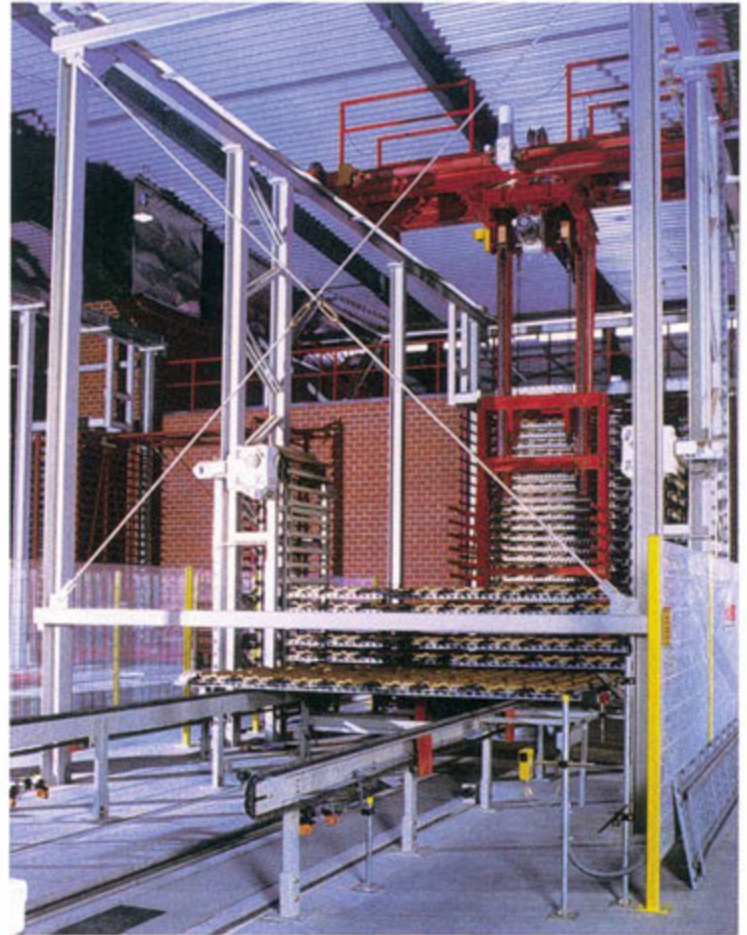
Die Beladung der Trocknerwagen Loading of dryer cars
