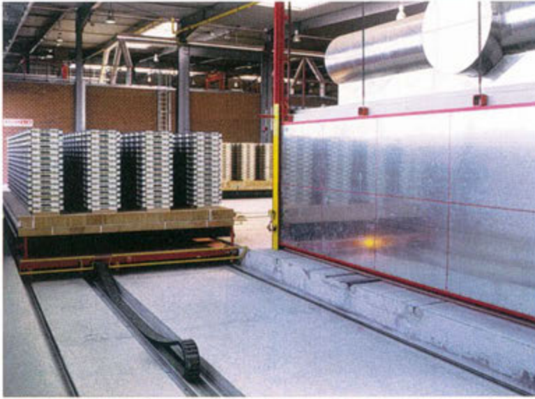
Der Ofenwagen wird von einer Schiebepöhrne verfahren und in den Vorwärmer eingeschoben The kiln car is moved by a transfer car and pushed into the pre-heater
