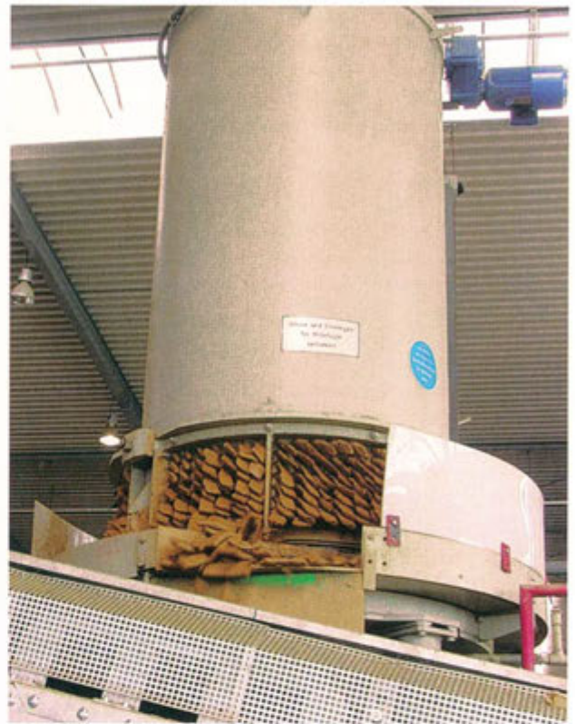
Händle-Siebrundbeschicker Type BRSH 12a Händle circular screen feeder Type BRSH 12a
