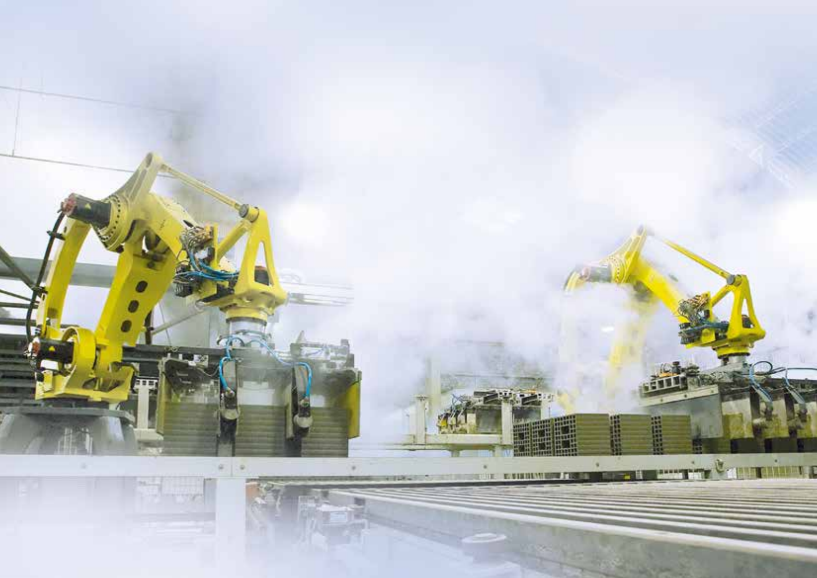
Beladung der trockenen Formlinge auf den Ofenwagen Loading of dry products on kiln cars
