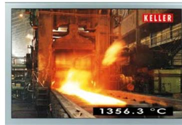
Zur optischen Ausrichtung kann bei den Geräten der Baureihe CellaTemp PA 40 zwischen einem Durchblickvisier, einem Laser oder einer Farbkamera ausgewählt werden. Die Messfeldmarkierung im Sucher bzw. auf dem Monitor kennzeichnet die exakte Größe und Position des Messfeldes.
