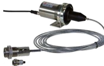
Bei beengten Montagebedingungen oder bei hohen Umgebungstemperaturen werden Geräte mit getrenntem optischen Messkopf und Lichtwellenleiter zur Übertragung der Infrarotstrahlung auf die Auswertelektronik eingesetzt. Der Messkopf ist ohne Kühlung in Umgebungstemperaturen bis 250 °C verwendbar.
