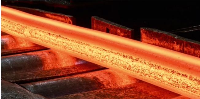
Zunder und Oxid verändern die Strahlungseigenschaften erheblich
