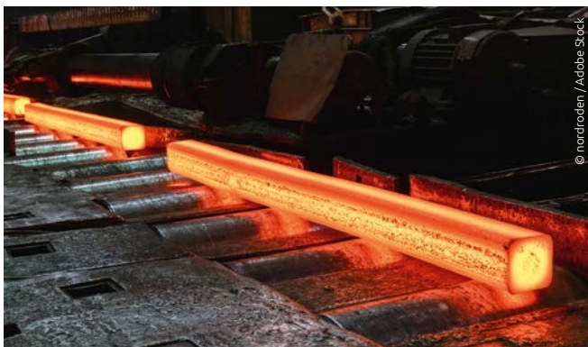
Zunder und Oxid verändern die Strahlungseigenschaften erheblich
