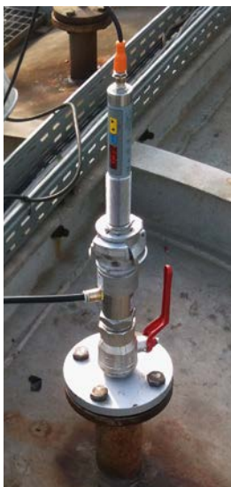
Pyrometer CellaTemp® PK mit Montagearmatur
