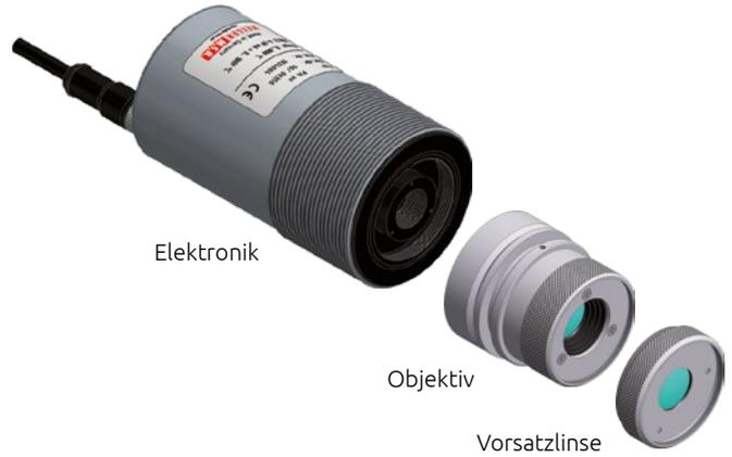
Das CellaTemp 43 wird mit 5 verschiedenen Objektiven angeboten. In Verbindung mit den optional zu verwendenden Vorsatzlinsen ergeben sich mehr als 40 verschiedene optische Variationsmöglichkeiten für Messobjekte ab 0,1 mm.
