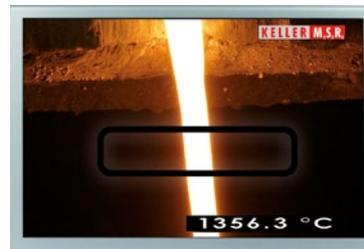
Zur optischen Ausrichtung kann zwischen einem Durchblickvisier, einem Laser oder einer Farbkamera ausgewählt werden. Die Messfeldmarkierung im Sucher bzw. auf dem Monitor kennzeichnet die exakte Größe und Position des Messfeldes.
