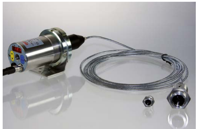
CellaTemp PA 21/31/41 mit Lichtleiterkopf Ø 30 mm und integriertem Laser-Pilotlicht zur Anzeige der exakten Position und Größe des Messfeldes.
